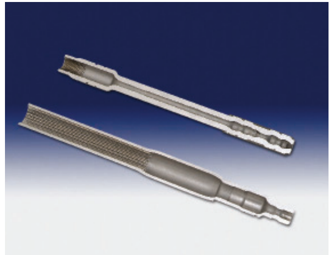
Enge Toleranzen sind ein weiteres Markenzeichen rundgekneteter Wellen.
